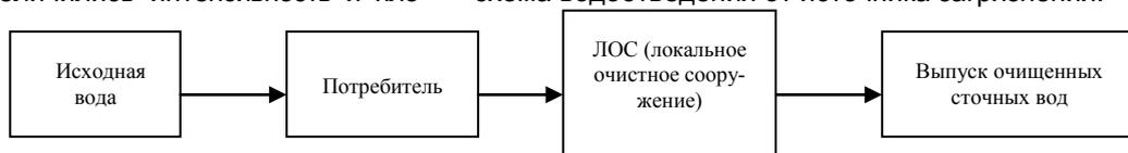
Рис. Схема водоотведения, включающая станцию биологической очистки.
