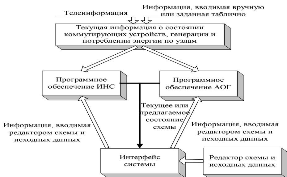
Рис. 3. Блок-схема программного обеспечения системы.
