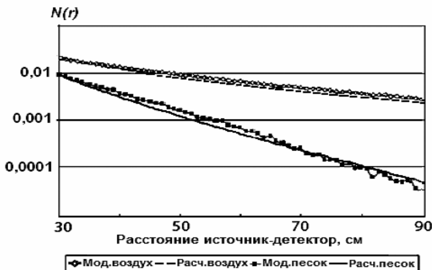
Рис.1. Сравнение результатов компьютерного моделирования с теоретическими расчетами в лучевом приближении для точечного источника ( 10^5 испытаний).
