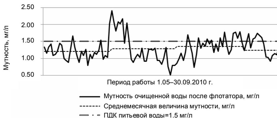
Рис. 8. Эффективность осветления коагулированной воды напорной флотацией по мутности после оптимизации работы ВОС (2010 г.).
