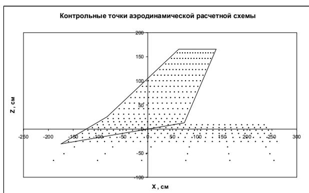
Рис. 2. Распределение контрольных точек по поверхности ГО и прилегающей части фюзеляжа.
