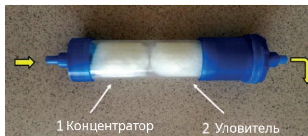
Рисунок 1. Колонка для испытаний волокнистых материалов (желтой стрелкой указано направление потока модельной сточной воды). Figure 1. Column for testing fibrous materials (the yellow arrow indicates the direction of flow of the model wastewater).
